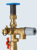
Sikkerhedsaggregat vedlagt. Med sikkerhedsventil, kontraventil, afspærringsventil og tømmeventil. 10 bar.
